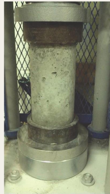
混凝土(受壓力破壞)
