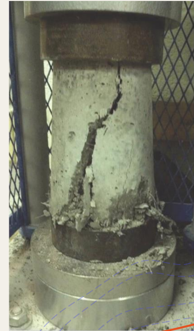
混凝土(受壓力破壞)
